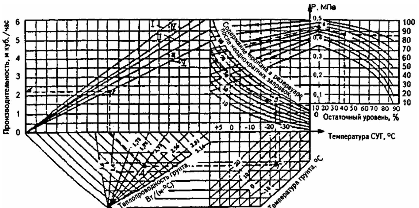
Номограмма для определения производительности резервуара сжиженного газа вместимостью  $2,5$  и  $5 \text{ м}^3$  (подземного)
